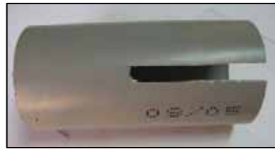
2. نفتح فتحة بقسطل ال 3 أنش لتثبيت عدسة المكبر .
